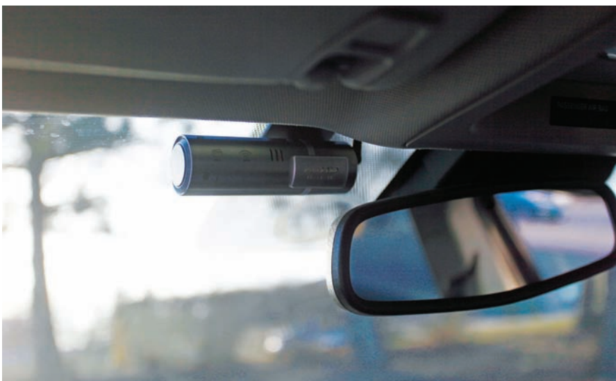
Видеорегистратор, закрепленный в салоне автомобиля
